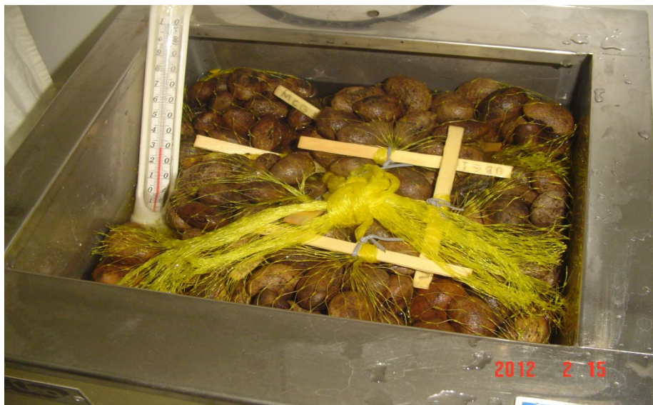
Figura 04: Equipamento de banho-maria utilizado para a quebra de dormência de sementes de pequi submetidas ao tratamento térmico (30°C, 40°C, 50°C) durante 5 e 10 minutos; Termômetro com oscilação de \pm 2^{\circ}\text{C} .
