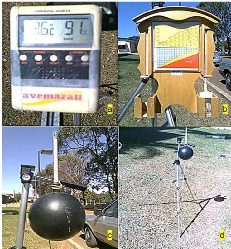
Figura 26. a) Psicrômetro, b) Termômetros de bulbo seco e bulbo úmido, c) Globo negro com termômetro, d) Suporte tripé. Foto: Autor
