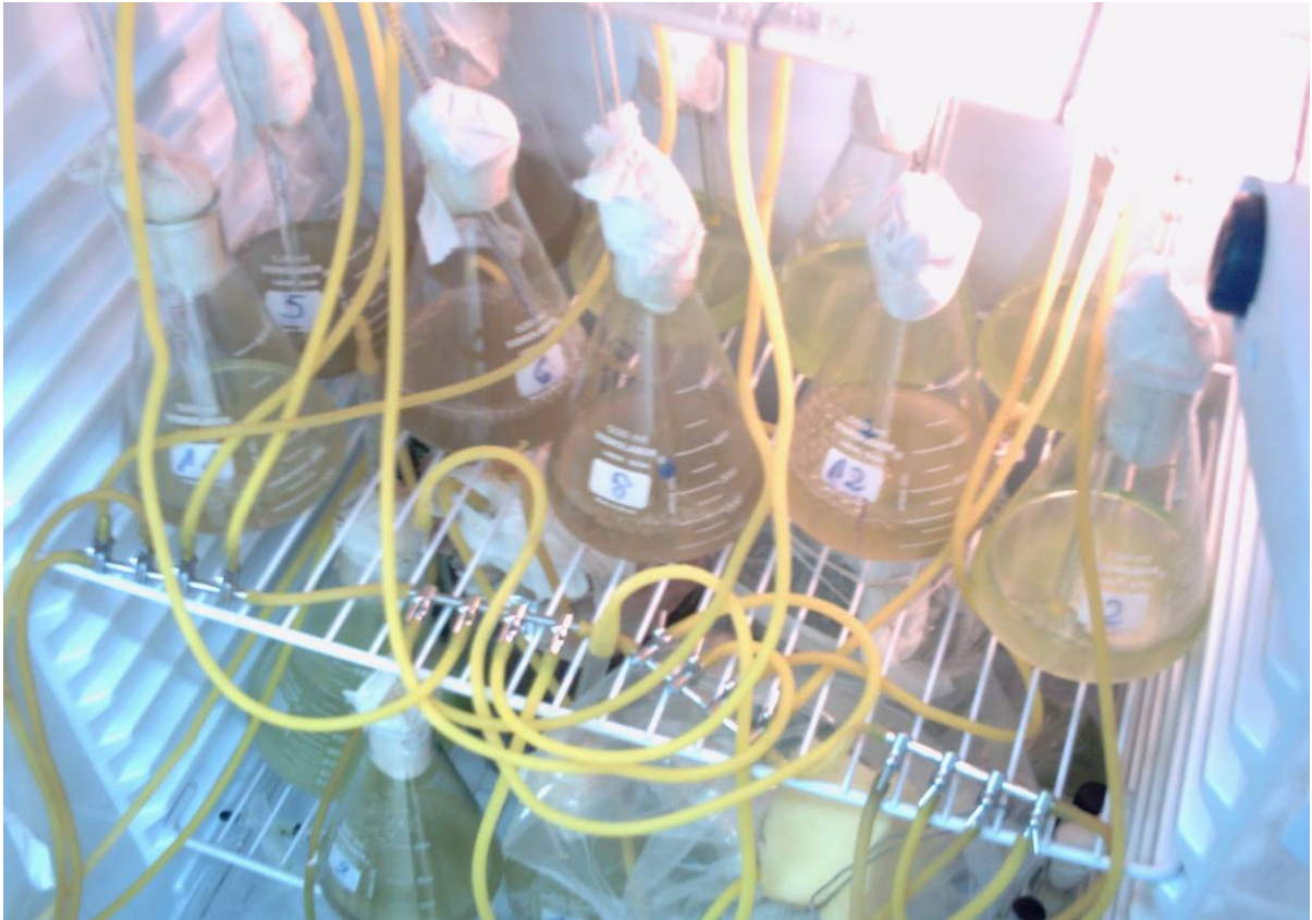
Figura 2. Experimento instalado: Aerador com filtro milipore distribuidores de ar na câmara de cultivo.
