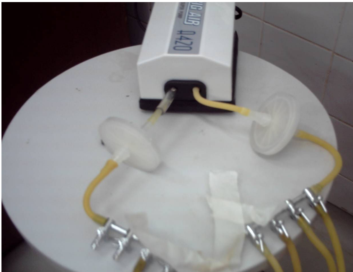
Figura 3. Sistema de aeração, filtragem e distribuição de ar para o cultivo.
