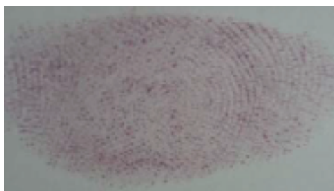
Figura 12: Impressão digital depositada em papel do tipo A4, revelada com o reagente ninidrina
