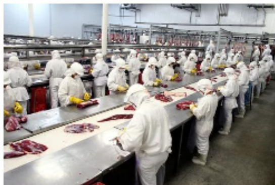
Figura 3.12 - Foto da desossa da carcaça
