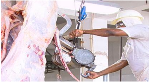
Figura 3.9 - Foto da serragem da carcaça
