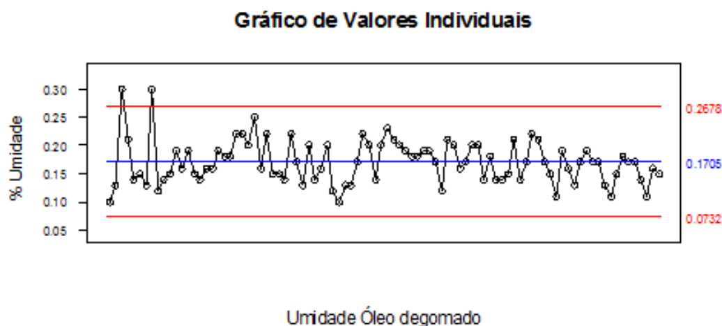
Figura 50 – Gráfico de Valores Individuais – Umidade Óleo degomado
