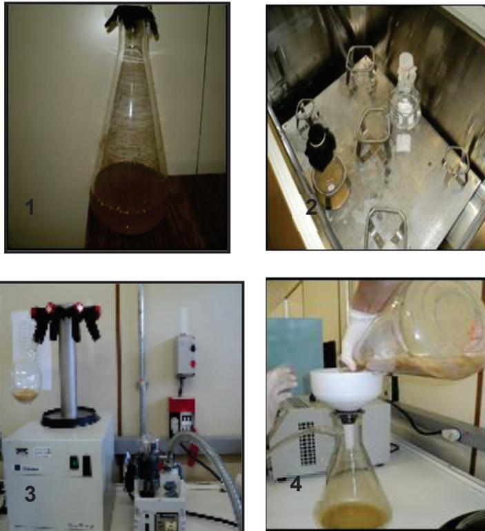
**Figura 3.** Seqüência dos eventos para a produção da enzima amilase:. 1) Linhagem utilizada e manutenção do fungo em elermeyer de capacidade de 1 L; 2) Inoculação em aparelho Shacker; 3) Liofilização para concentrar a solução enzimática; 4) Filtragem á vácuo em filtros de papel.
