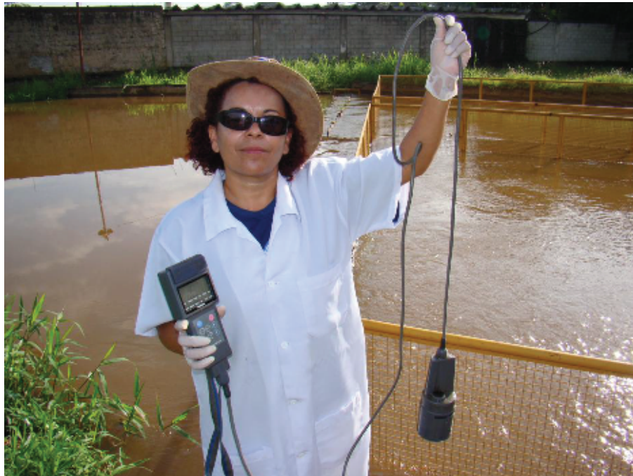
Foto 1. Uso da sonda multiparamétrica nas análises campo. Fonte: a autora, 2012.
