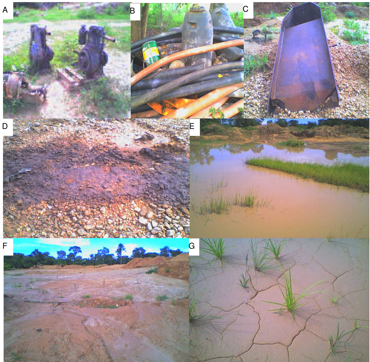
Figura 15: Equipamentos e consequências ambientais do garimpo por dragagem em 2006 (Fotos: Silva, 2007). A – Motores a combustão usados na exploração aurífera nas margens do Córrego Vermelho; B – Mangueiras usadas na maraca; C – Bica abandonada nas margens do Córrego Vermelho; D – Derrame de óleo diesel nas bordas do Córrego Vermelho; E – Cata sendo entupida com polpa (melechete: nome popular para a lama aurífera); F – Deposição da polpa aurífera após passar pela bica; G – Melechete.
