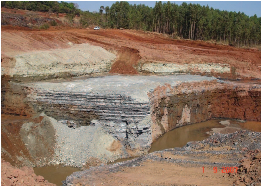
Figura 4- Área em lavra, foi retirado o solo e o argilito, que foram recuperados por carregadeira e caminhões.
