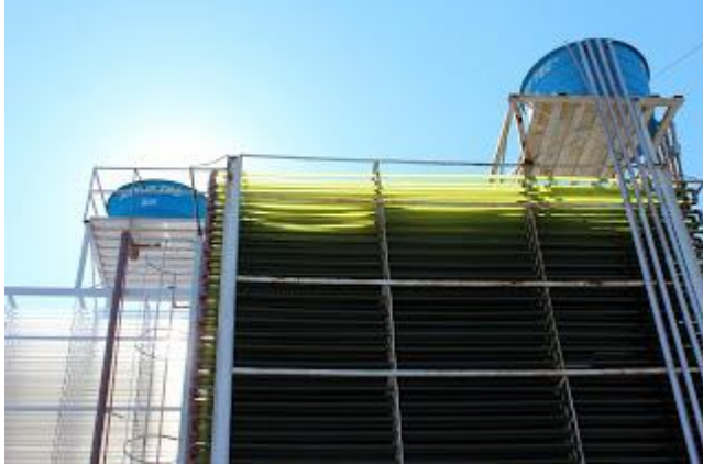
Figura 07: Fotobiorreator tubular fechado, Curitiba, Paraná, Brasil.
