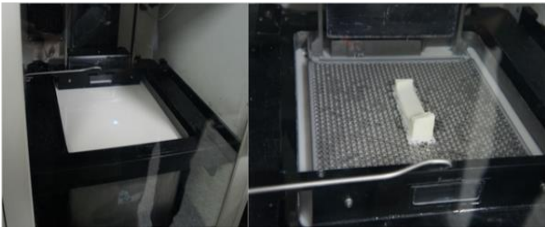
Figura 9 - À esquerda: resina sendo atingida por um laser; à direita: produto sendo elevado. 116
