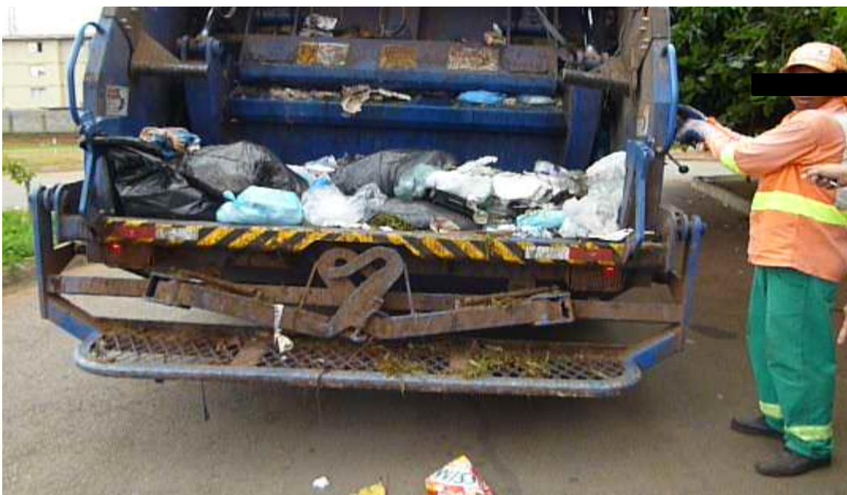
Figura 2 – O coletor acionando a alavanca do compactador
