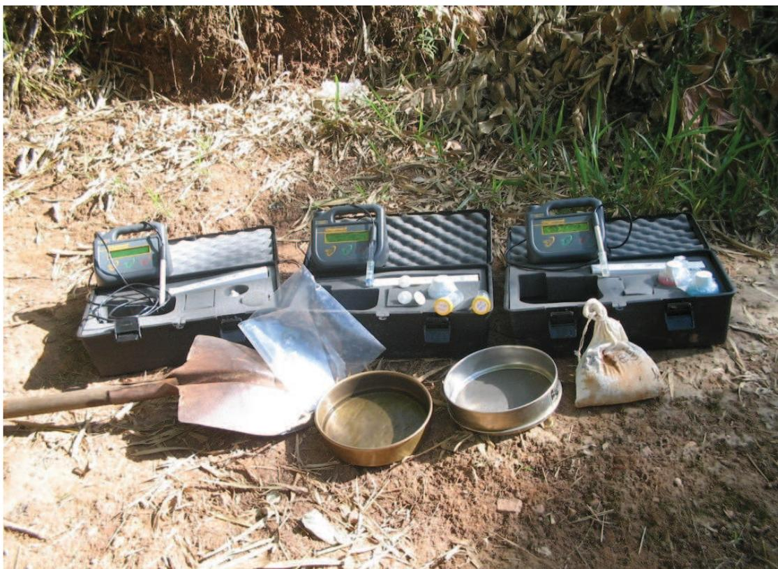
**Figura 7.** Kit completo para amostragem de água e sedimento de corrente.
