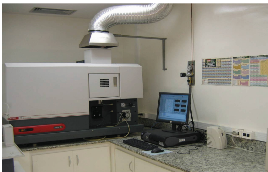
Figura 11. Espectrômetro de emissão atômica por plasma de argônio induzido (ICP OES). Laboratório de Espectroscopia Atômica Aplicada – LEAA/UCB.
