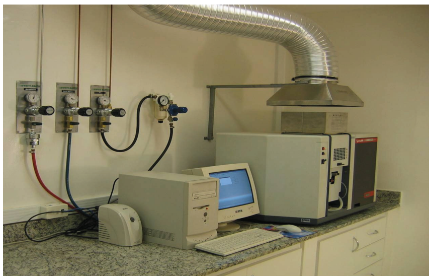
Figura 12. Espectrômetro de absorção atômica (AAS). Laboratório de Espectroscopia Atômica Aplicada – LEAA/UCB.
