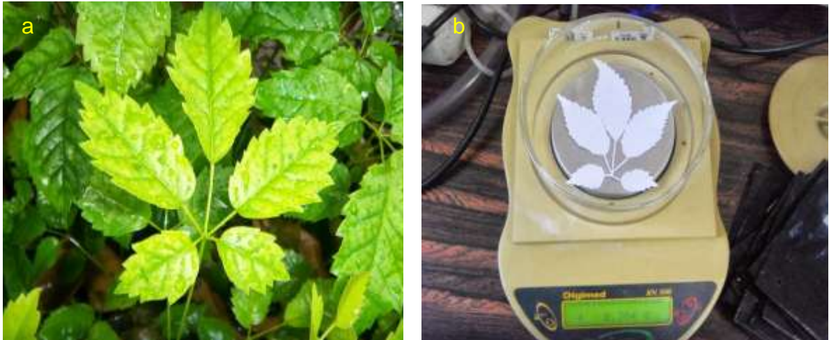
Figura 06: a - Folha de uma planta de H. serratifolius . b - Pesagem do desenho de uma folha de H. serratifolius em balança digital de precisão (0,001g)
