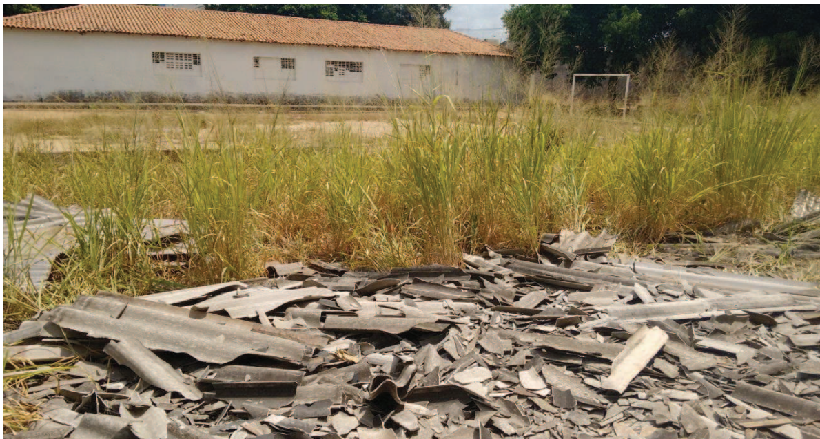
Figura 18 - Presença de amianto em entulho encontrado na escola 18
