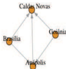
Figura 8 – Grafo fracamente conectado
