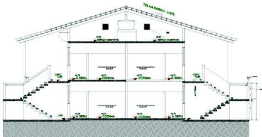
CORTE TRANSVERSAL – CASA SOBREPOSTAS - 2 QUARTOS S/ESCALA
