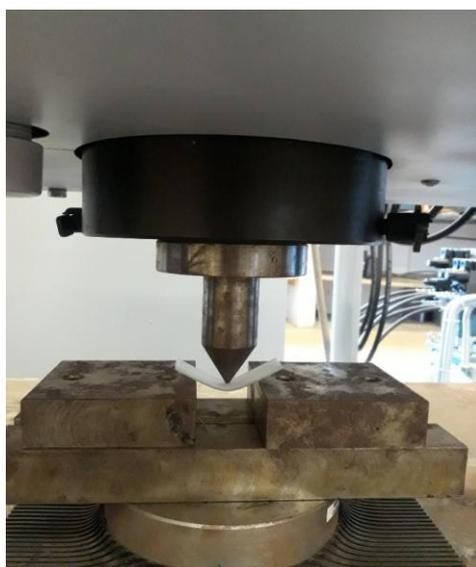
Figura 61 - Máquina de ensaio mecânico de flexão.
