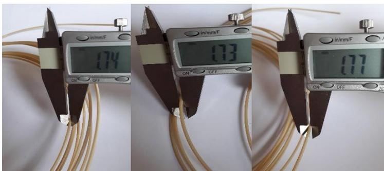
Figura 51 - Medição do diâmetro do filamento com ABS reciclado.
