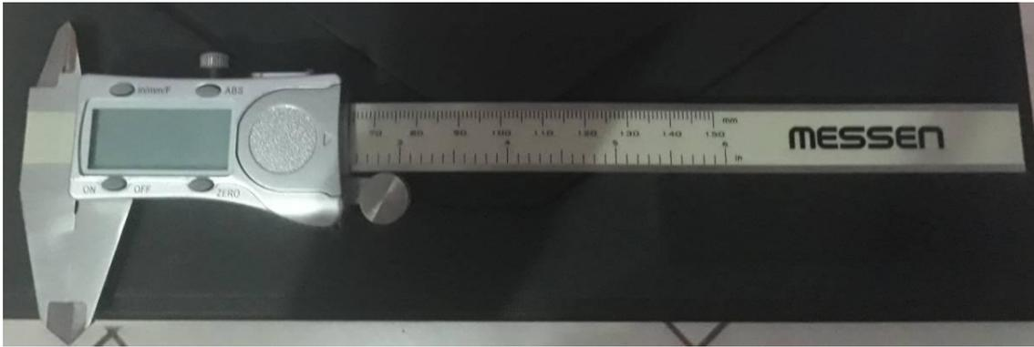
Figura 19 - Paquímetro digital.
