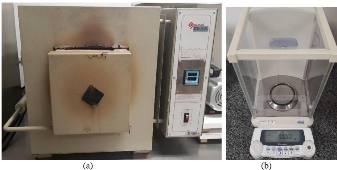
Figura 12 - Equipamentos utilizados: (a) Mufla; e (b) Balança de precisão.
