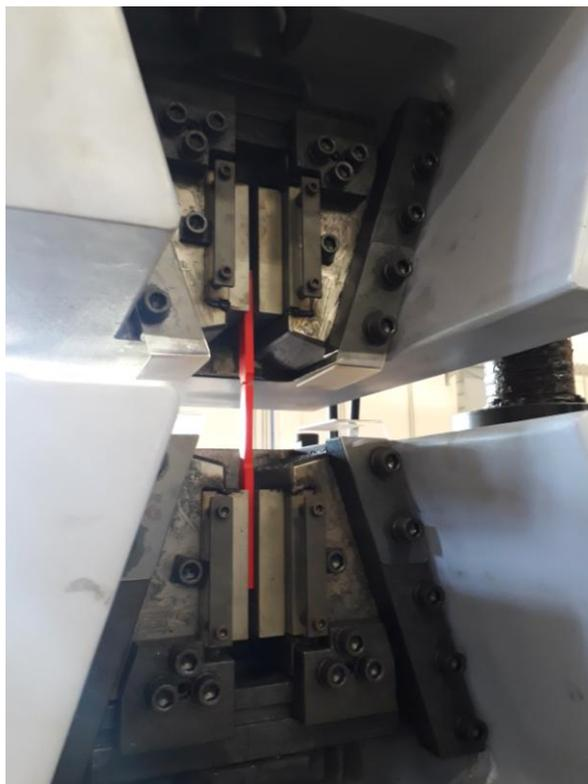
Figura 59 - Máquina de ensaio mecânico de tração.
