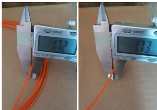
Figura 56 - Medição do diâmetro do filamento PLA laranja reciclado.
