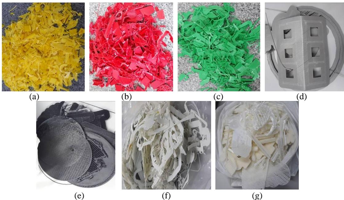
Figura 15 - Material para ser triturado: (a) ABS amarelo; (b) ABS vermelho; (c) ABS verde; (d) ABS cinza; (e) ABS preto; (f) ABS natural; e (g) PLA natural.
