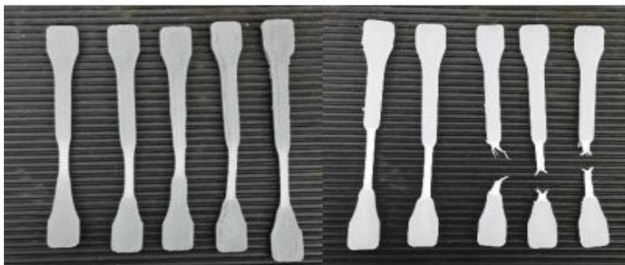
Figura 60 – Corpos de prova de tração impressos de PEAD reciclado e PEAD virgem (da esquerda para a direita).
