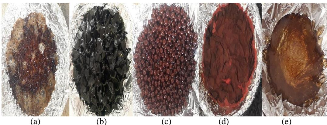
Figura 42 - Amostras na temperatura de 240 °C: (a) PLA no 3º ciclo; (b) PEAD no 2º ciclo; (c) ABS no 4º ciclo PEAD no 2º ciclo; (d) PP no 6º ciclo; (e) PETG no 9º ciclo.
