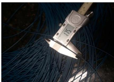
Figura 55 - Medição do diâmetro do filamento do PEAD com puxador a temperatura de 290 °C.
