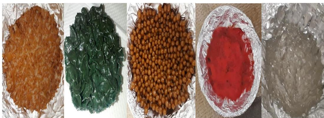
Figura 36 - Amostras na temperatura de 200 °C: (a) PLA no 7º ciclo; (b) PEAD no 5º ciclo; (c) ABS no 7º ciclo; (d) PP no 10º ciclo; (e) PETG no 10º ciclo.
