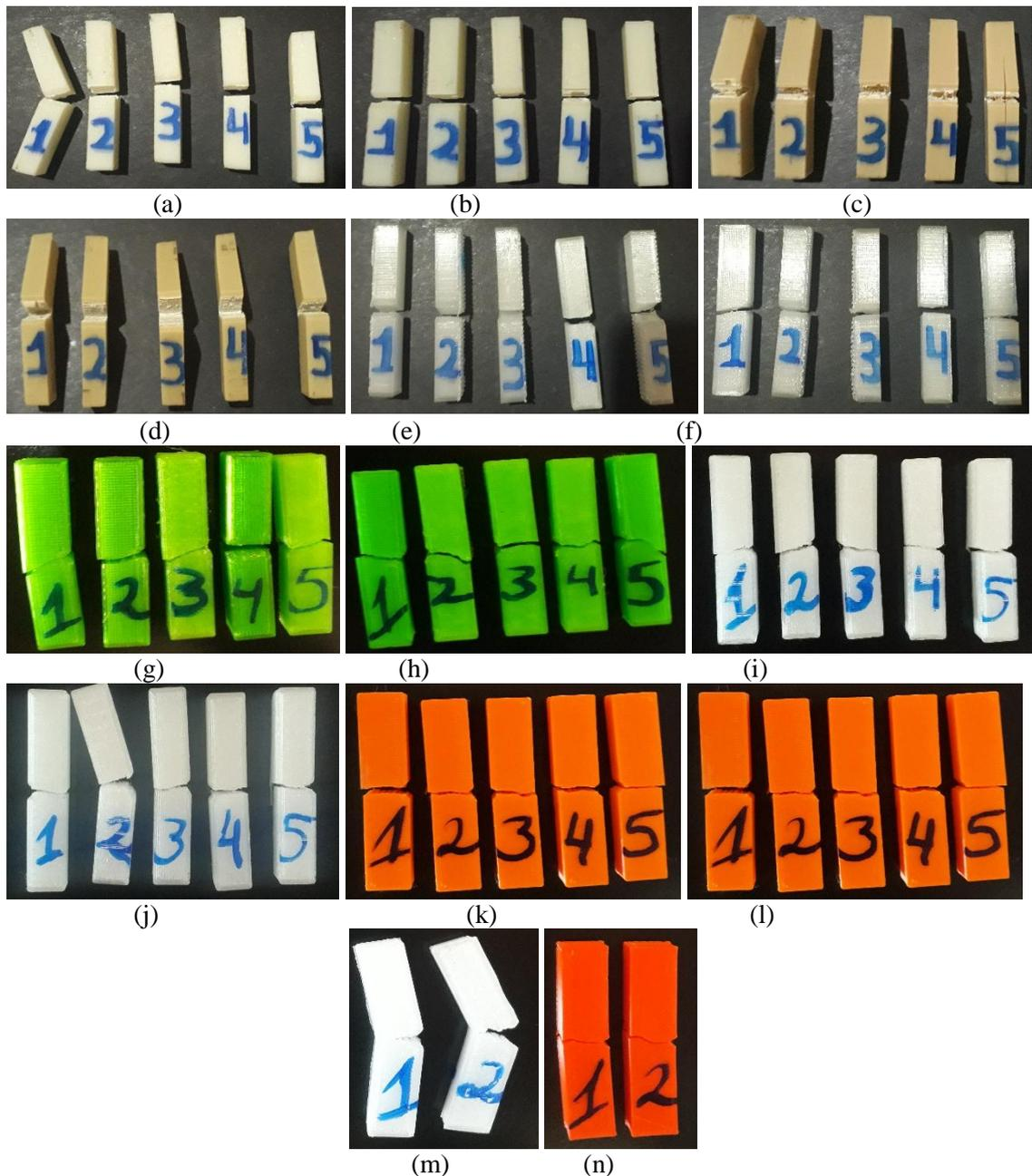
Figura 84 - Amostras finais após os ensaios de impacto: (a) ABS Virgem 50%; (b) ABS Virgem 35%; (c) ABS Reciclado 50%; (d) ABS Reciclado 35%; (e) PETG Virgem 50%; (f) PETG Virgem 35%; (g) PETG Reciclado 50%; (h) PETG Reciclado 35%; (i) PLA Virgem 50%; (j) PLA Virgem 35%; (k) PLA Reciclado 50%; (l) PLA Reciclado 35%; (m) PP Virgem 50%; (n) PP Reciclado 50%.
