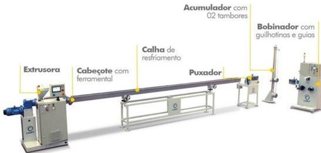
Figura 21 - Extrusora de filamento para impressora 3D.
