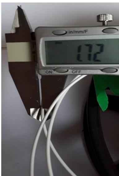
Figura 53 - Medição do diâmetro do filamento ABS virgem.
