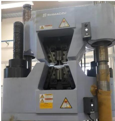
Figura 25 - Equipamento para ensaio de tração.
