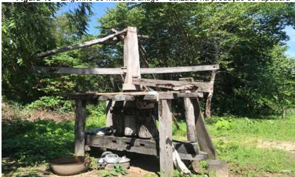
Figura 46 – Engenho de madeira antigo – utilizado na produção de rapadura 12
