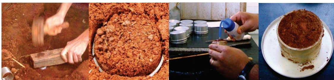
Figura 9. Sequência da coleta e preparo do material para análise de densidade do solo e porosidade total.
