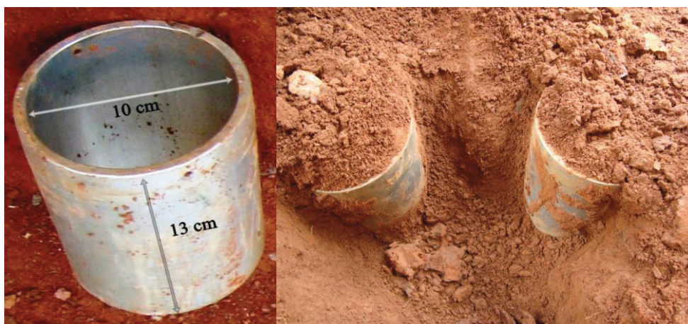
Figura 7: Extrator de aço para a coleta de amostras indeformadas de solo utilizadas para a determinação da permeabilidade do solo.
