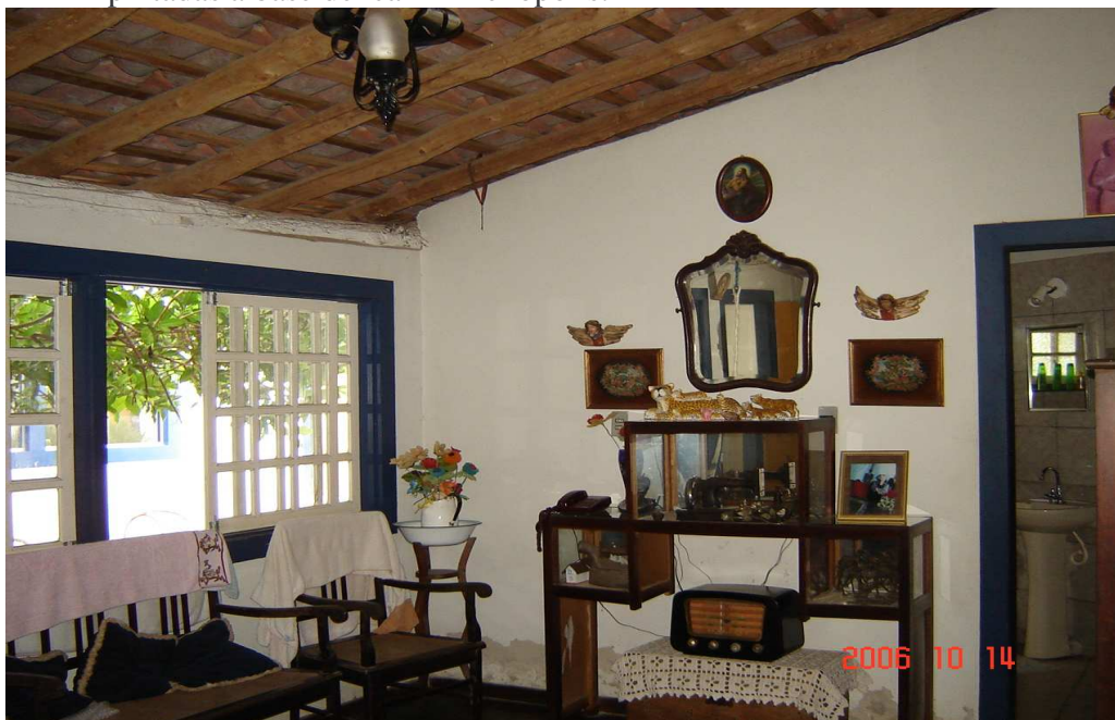
Foto 1: Pousada de Dona Geni: Forro de madeira e paredes revestidas e pintadas à base de cal – Pirenópolis.
