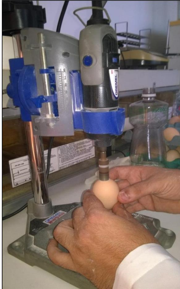
**Figura 17.** Abertura circular na base maior do ovo com uso de micro-retífica
