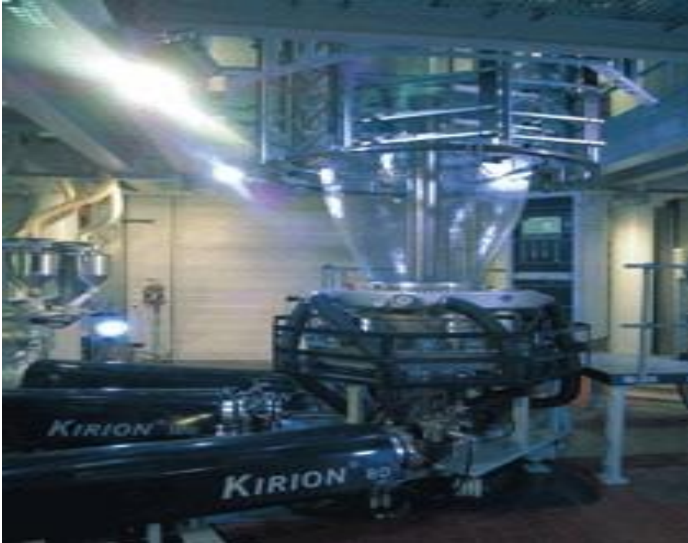
Figura 6: Extrusão de filme tubular Fonte: AZEVEDO (2004)
