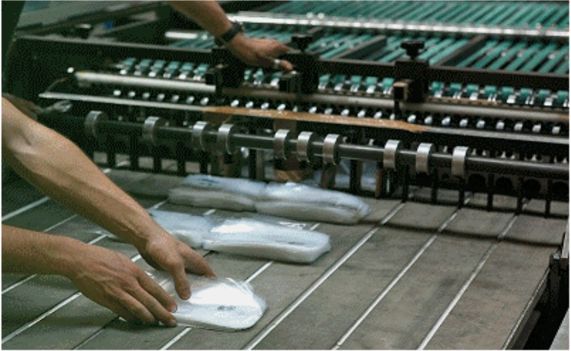
Figura 15: Produção final de sacos na máquina de corte e solda Fonte: Adaptado de PLASTIRSO (2013)
