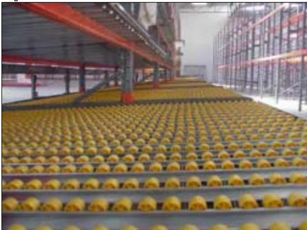
Figura 7 – Rodas sobre trilhos no sistema Flow Rack
