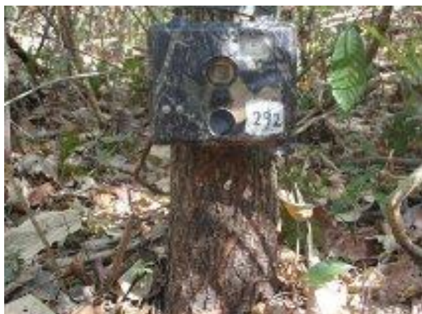
Figura 2- A- Armadilha Fotográfica fixada em campo, B- visualização de uma câmera com a caixa acoplada aberta: mostrando o sensor de infravermelho (ao meio), regulagem dos intervalos para cada foto (1, 5 ou 10 min) à esquerda e regulagem do tempo de funcionamento (12 horas ou 24 horas) também à esquerda , C- instalação de uma câmera em um dos fragmentos estudados.
