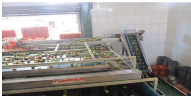
Após classificação, os tomates caem diretamente em caixas que são retiradas manualmente e pesadas e empilhadas em paletes. As caixas são colocadas em paletes para facilitar o transporte dos produtos, que podem ser retiradas por empilhadeira ou por mão de obra de carregadores com carrinhos manuais.
