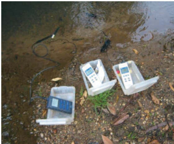
Figura 5 - Aparelhos para realizar análises dos parâmetros físico-químicos.
