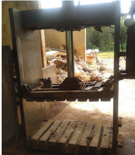
Figura 12: Máquina que faz a prensa dos resíduos coletados
