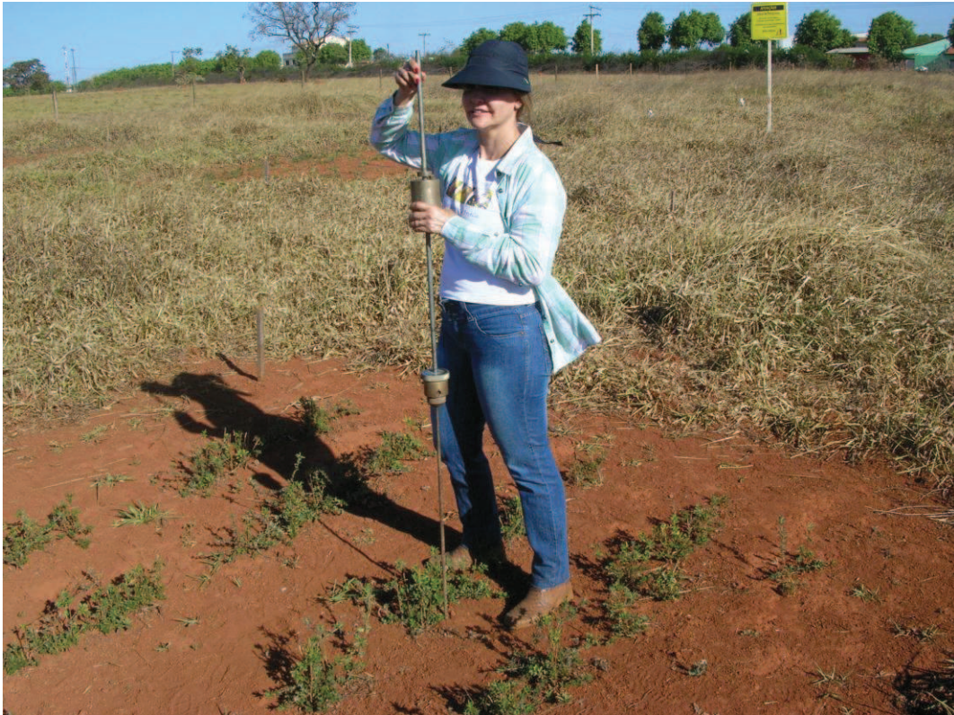
Coleta de solo nos canteiros com aparelho Penetrômetro de Impacto.
