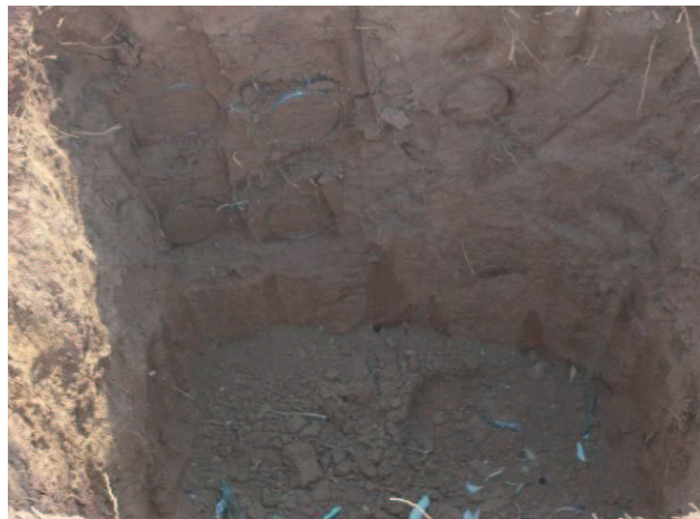
Ângulo mostrando os anéis de Kopeck em vala na coleta do solo.
