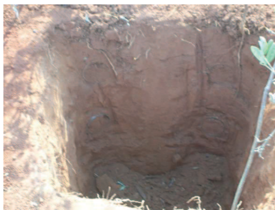
Outro ângulo para a visualização dos anéis de kopeck em vala na coleta do solo.
