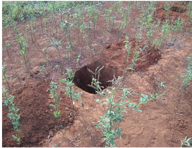
Canteiro de feijão Guandu com vala para coleta do solo com anéis de Kopeck
