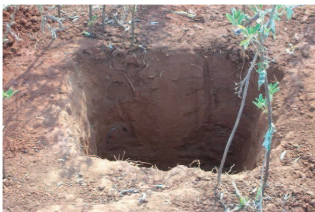
Vala para coleta de amostra do solo com anel de Kopeck para a determinação da densidade do solo (DS) no canteiro de Feijão Guandu.
