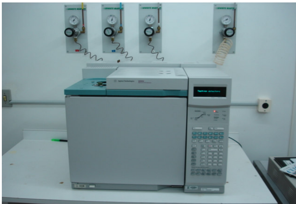
Figura 12: Cromatógrafo a gás Agilent 6890, série II, equipado com detector de ionização de chama, FID e injetor/split/splitless.
