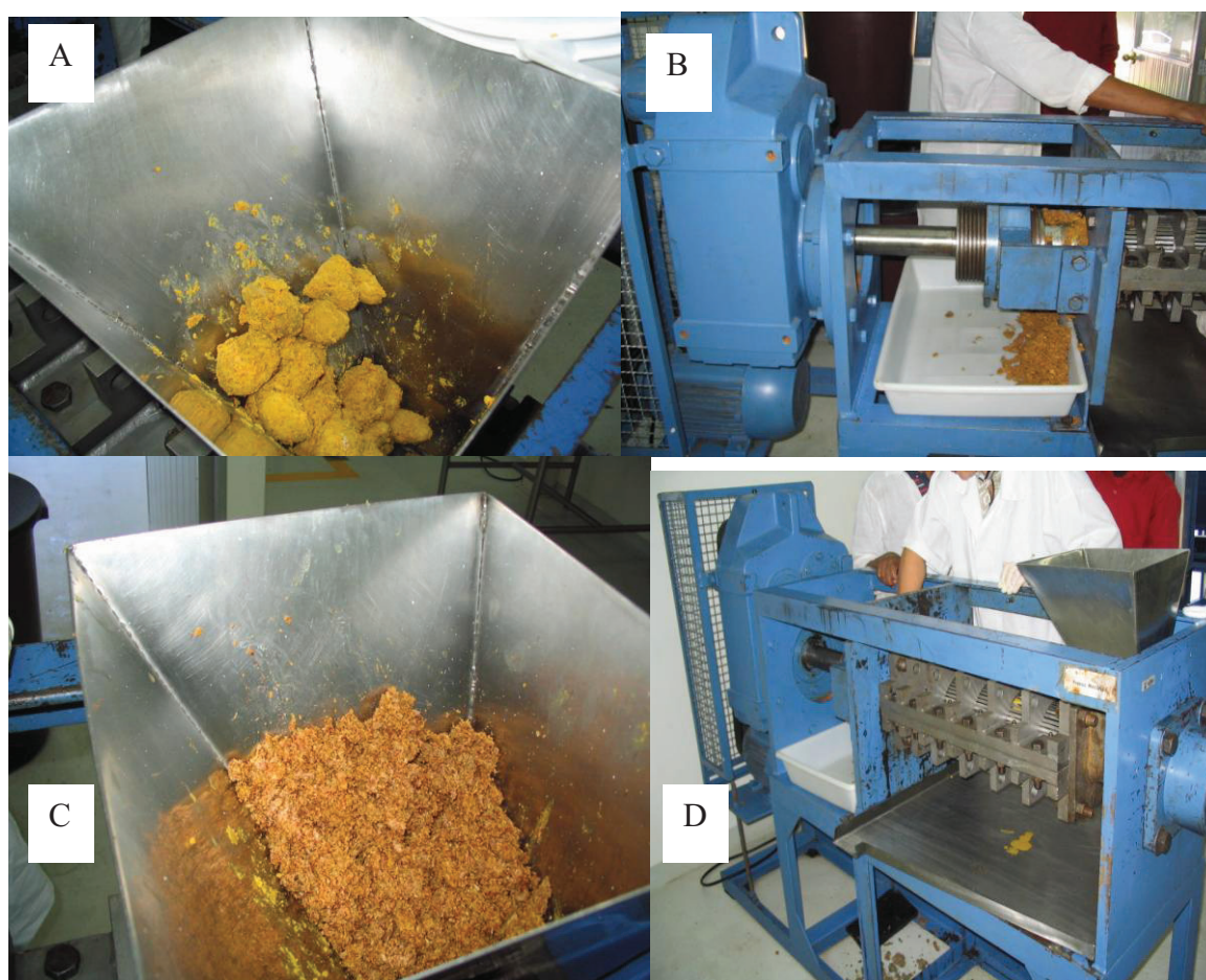
FIGURA 4: A) Carroços no cone da prensa. B) obtenção da torta (resíduo da amostra); C) torta no cone da prensa (2 a passagem); D) obtenção da mistura de óleo, polpa e espinhos.
