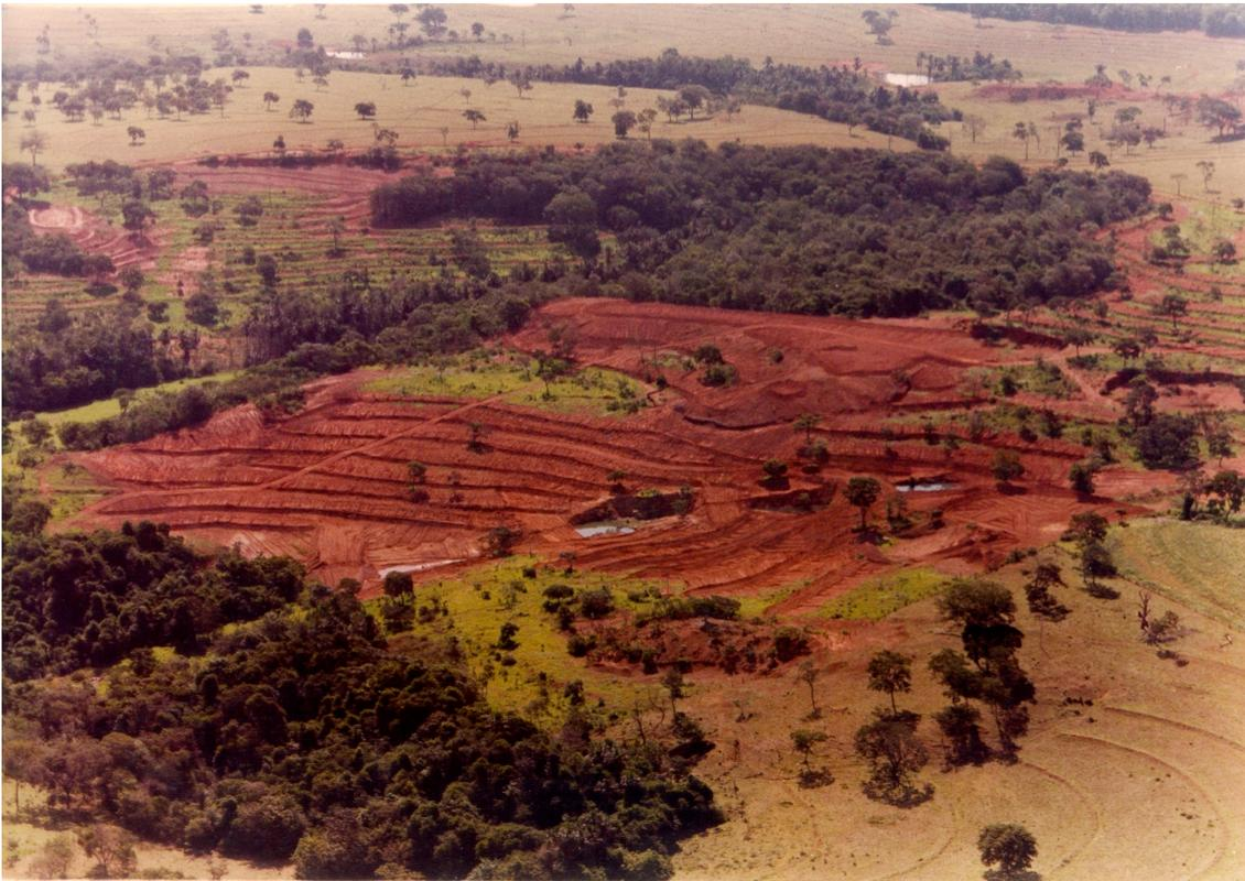
**Figura 1 – Ilustra a técnica de terraceamento utilizada às margens do Ribeirão Abóbora para recuperação do solo<sup>58</sup>**
