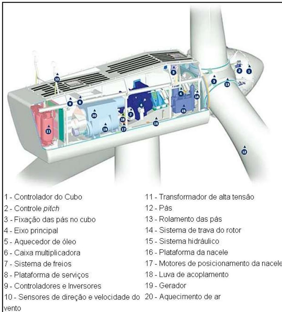
**Figura 15:** Vista do interior da nacele utilizando gerador multipolos
