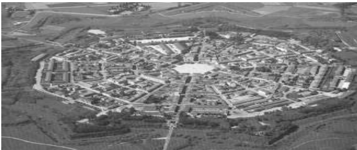
FIGURA 04 - Palmanova, Itália. A forma da cidade, de traçado regular e concêntrico, está inserida em um polígono regular de oito lados, em cujos vértices são construídos contrafortes para facilitar a defesa da cidade. A forma das muralhas também é modificada em função da introdução de novos armamentos — principalmente o canhão — e de novas táticas de guerra. Esta forma de cidade será conhecida como “planta em estrela”.
