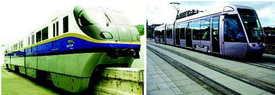
Figura 11: exemplo de um típico monotrilho (esquerda) e um VLT clássico que circula em dois trilhos.
