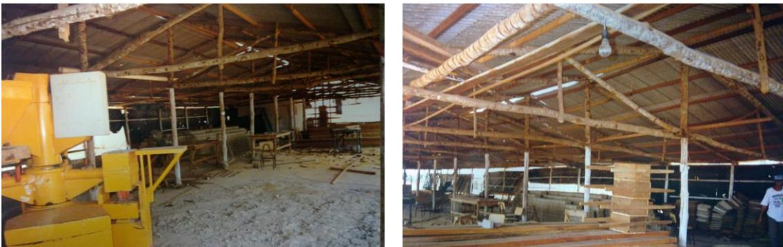
Figuras 18 e 19 – Canteiro de obras da COPHOG. À esquerda, máquina de fabricação dos tijolos e à direita, os tijolos fabricados, empilhados em suas formas.
