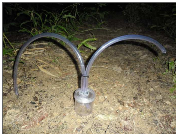
Figura 19. Foto do aparato (tubo de sucção) utilizado para coleta dos anofelinos. Fonte: Biota Projetos e Consultoria Ambiental Ltda, 2012.
