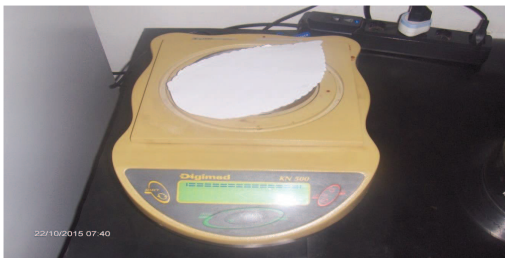
Figura 9 - Pesagem de contornos foliares da espécie Solenostemon scutellarioides para mensuração da área foliar
