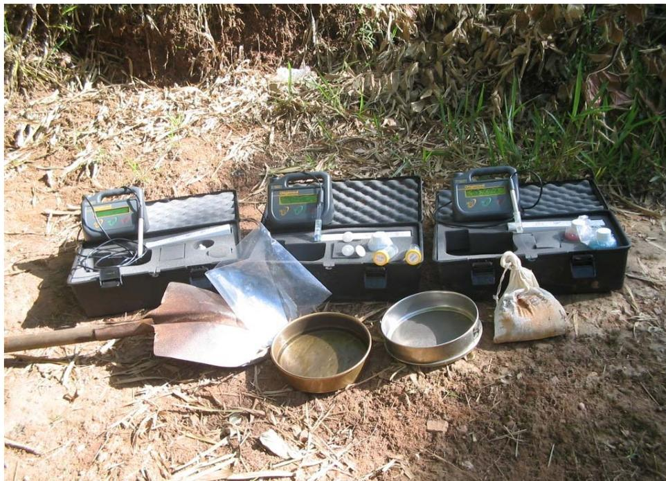
Foto 1 – Kit completo para amostragem de sedimentos de corrente e água (CUNHA & MACHADO, 2003).
