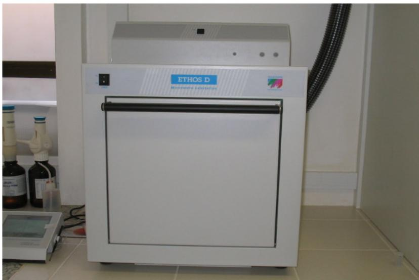
**FIGURA 6.** Sistema de digestão fechado assistido por microondas. Laboratório de Espectroscopia Atômica Aplicada – LEAA/UCB
