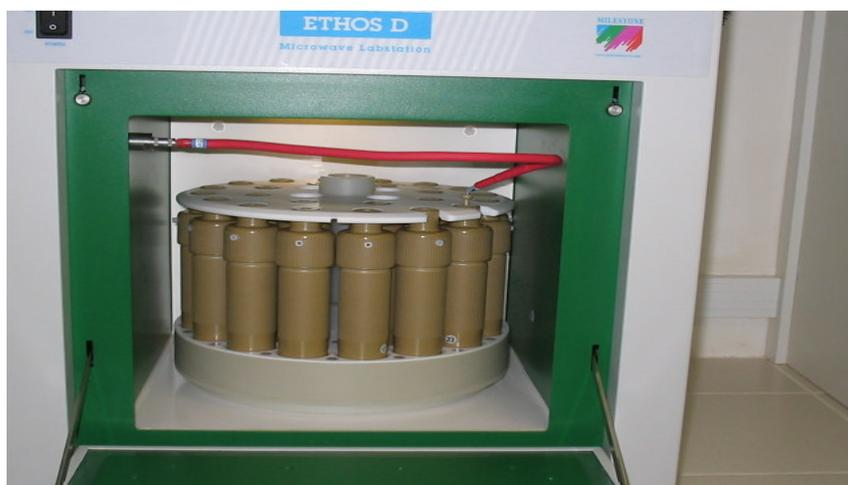
**FIGURA 7.** Tubos de digestão alocados no rotor dos sistema de digestão assistido por microondas. Laboratório de Espectroscopia Atômica Aplicada – LEAA/UCB
