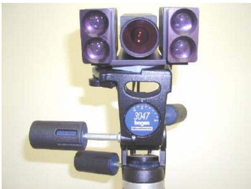
Figura 8. Câmera de infravermelho utilizada na análise computadorizada da marcha no Laboratório do Movimento da Universidade Estadual de Goiás.
