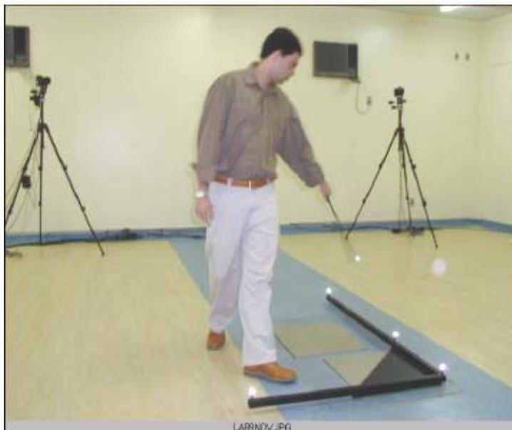
Figura 9. Calibração das câmeras, das plataformas de força e dos sistemas de coordenadas do Laboratório do Movimento da Universidade Estadual de Goiás.
