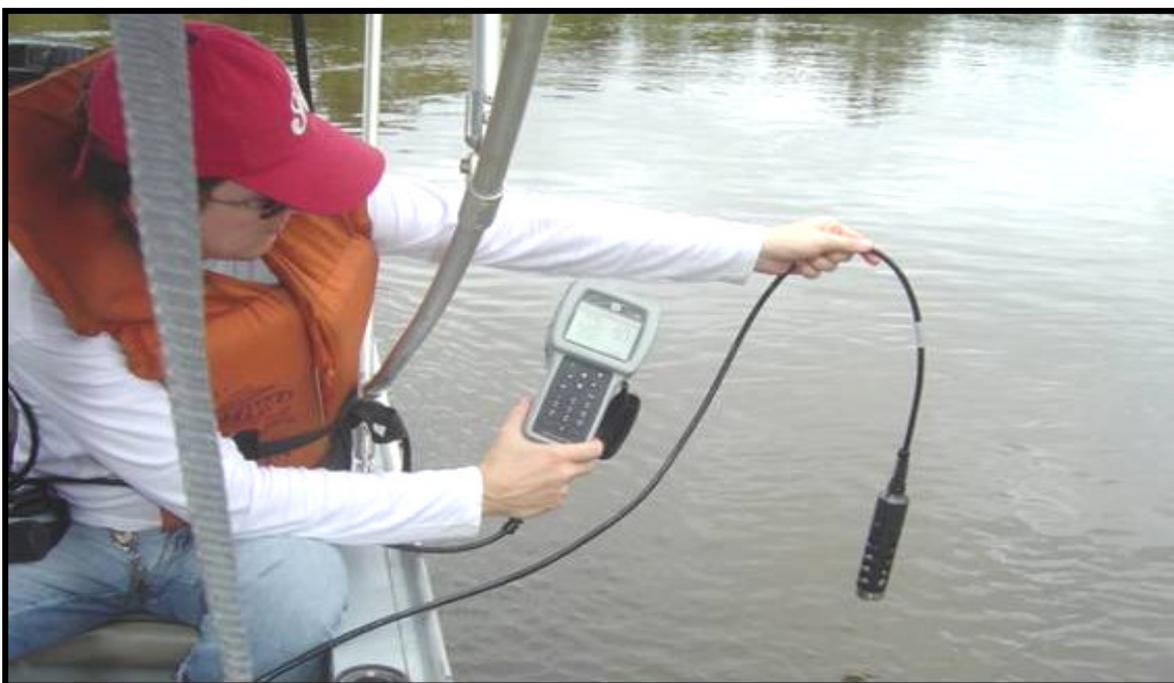
**Figura 5:** Determinação “*in loco*” dos parâmetros pH, condutividade elétrica, oxigênio dissolvido, temperatura e turbidez utilizando sonda multiparâmetros.
