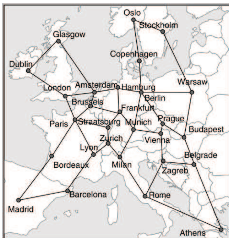
Figura 3 – Redes ópticas baseadas em malhas.
