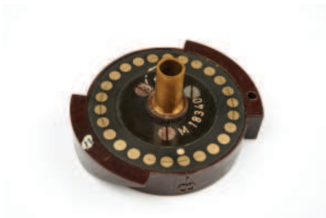
Figura 81 – Refletor da máquina Enigma M4
