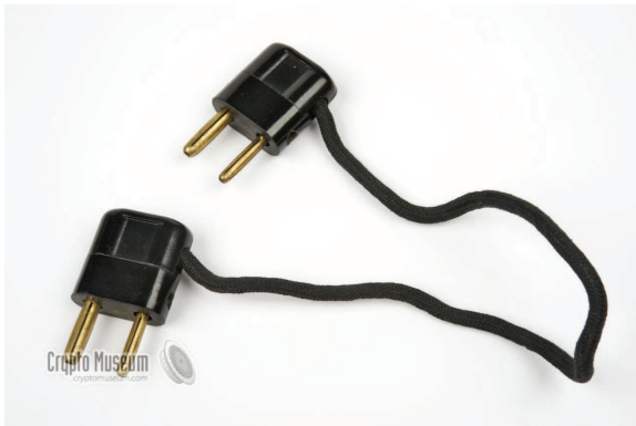
Figura 67 – Conectores do Steckerbrett
