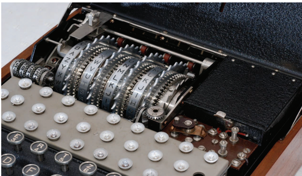
Figura 83 - Zählwerk Enigma sem a tampa superior
