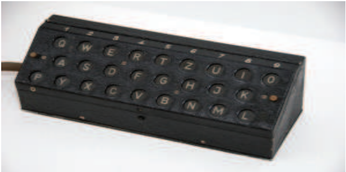
Figura 90: Painel de lâmpadas adicional
