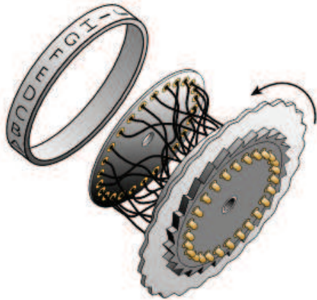
Figura 64 – Rotor (roda ou tambor) da máquina de cifragem Enigma
