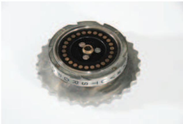
Figura 87 – Rotor da Enigma T com 5 entalhes de rotação
