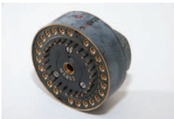
Figura 82 – Peça que substitui o rotor extra e o próprio rotor.
