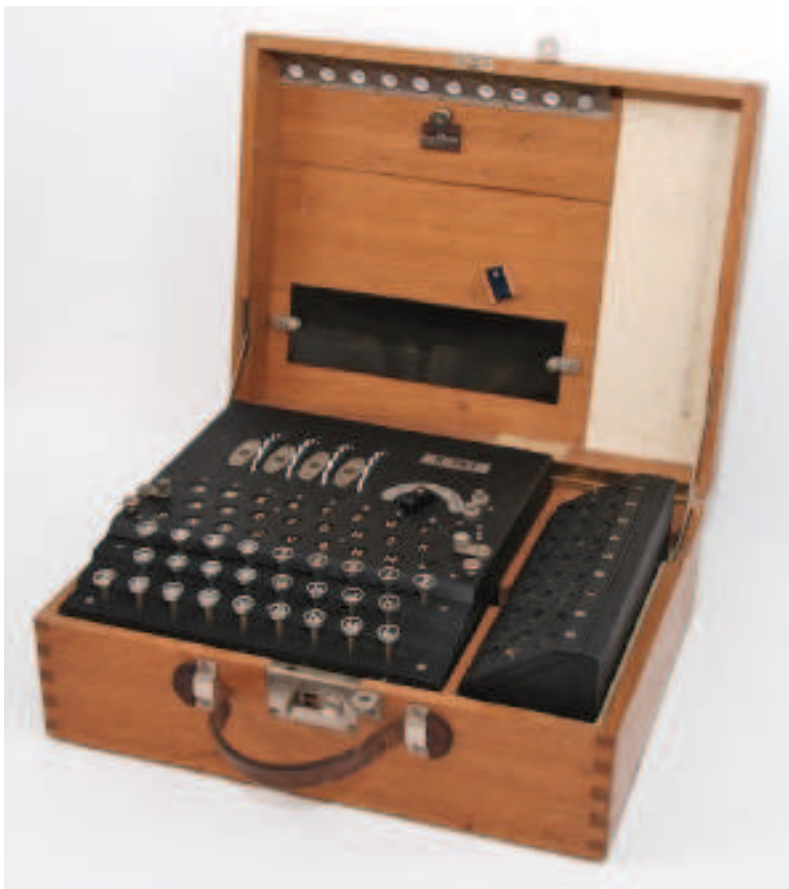
Figura 89 – Máquina de cifragem Swiss-K Enigma com um painel de lâmpadas adicional
