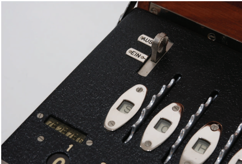
Figura 84 - Zählwerk Enigma com o contador de caracteres mostrando 7276
