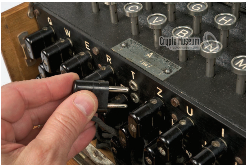
Figura 68 - Steckerbrett (placa de conexões ou painel de plugues) da Enigma A
