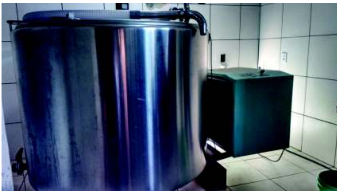
Figura 7: Tanque de armazenamento de leite
