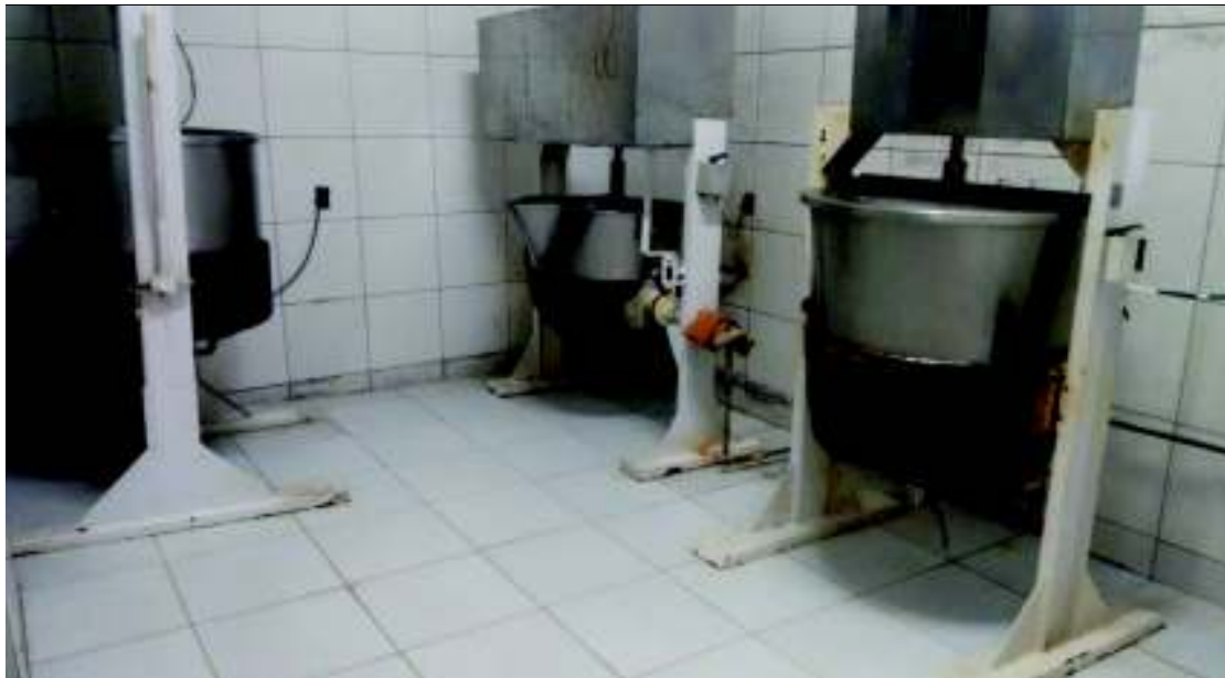
Figura 8: Tachos a vapor que recebem as matérias primas
