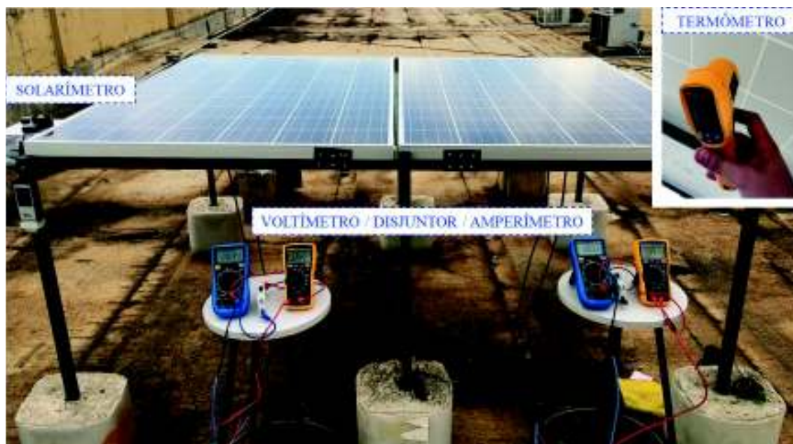
Figura 27 – Arranjo dos equipamentos utilizados no estudo 3.1.2.
