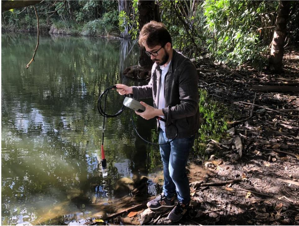
**Figura 7.** Coleta de dados limnológicos com o uso de uma sonda multiparamétrica. Foto Peterson Ferreira (2018).
