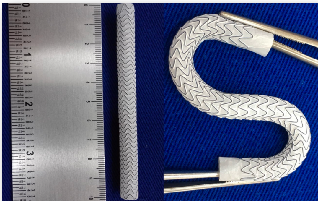
Figura 4. Protótipo final de stent vascular periférico recoberto por dupla camada de PTFE Bioweb®.
